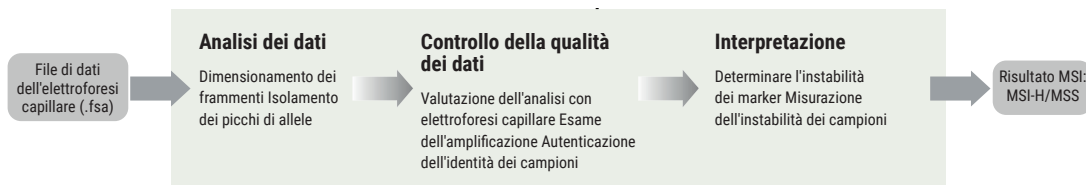
Figura 5. Flusso di lavoro dell'analisi per i dati dell'elettroforesi capillare dell'OncoMate™ MSI Dx Analysis System.
