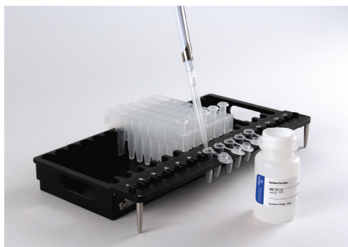
Figura 7. Preparazione e allestimento del vassoio. Nuclease-Free Water viene aggiunta alle Elution Tubes come indicato. Aprire le Elution Tubes prima di iniziare il metodo di estrazione.
