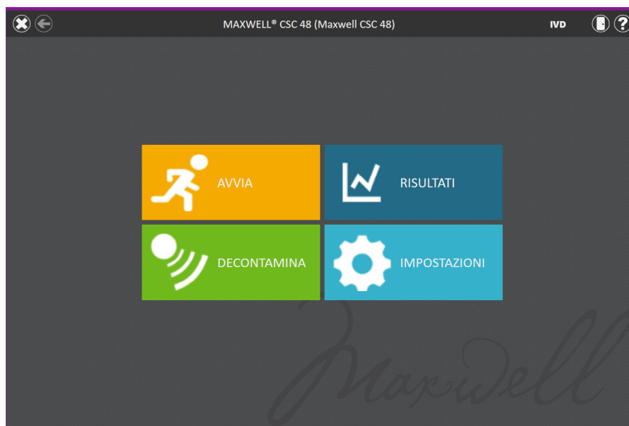
Figura 32. Schermata iniziale di Maxwell® CSC 48. La selezione del pulsante Avvia inizia il processo di esecuzione di un metodo di estrazione su Maxwell® CSC 48 Instrument.
