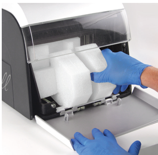
Figura 7. Rimuovere i due pezzi di spugna dall'interno dello strumento.
