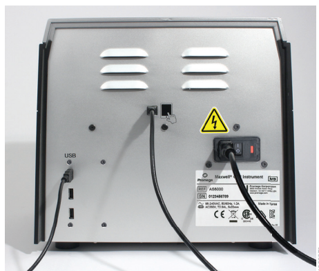
Figura 3. Vista posteriore del Maxwell® CSC Instrument. Parte posteriore dello strumento dove si notano l'interruttore di accensione/spengimento, il connettore del cavo di alimentazione, la porta di comunicazione USB strumento-tablet e tre porte di comunicazione USB aggiuntive per periferiche (p. es., lettore di codici a barre).
