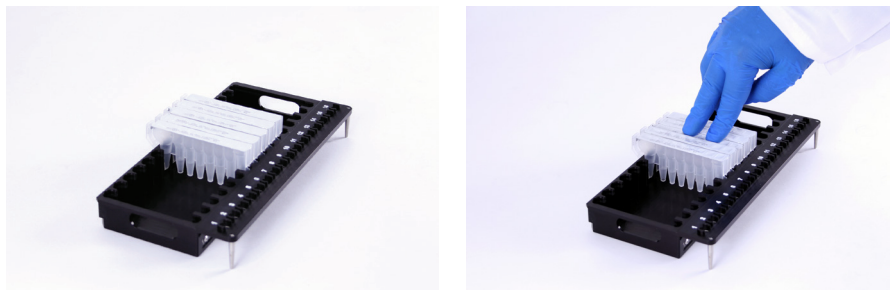
Figura 43. Posizionare le cartucce nel vassoio e premere con decisione finché non scattano in posizione.
