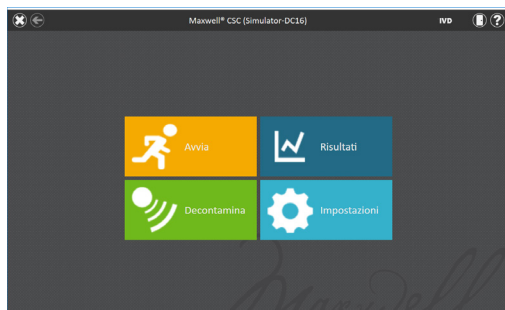
Figura 59. Schermata iniziale. Selezionando il pulsante Decontamina si inizia il processo di trattamento con luce UV del Maxwell® CSC Instrument.
