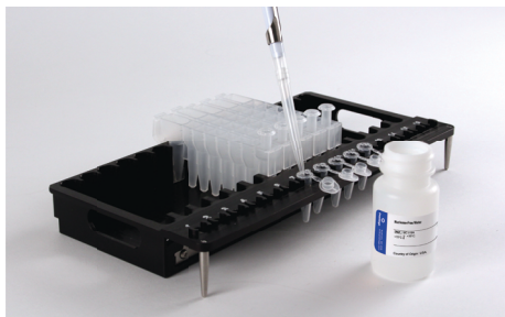
Figura 2. Preparazione e allestimento del vassoio. Nuclease-Free Water (50 µl) viene aggiunta alle provette di eluizione come indicato.
