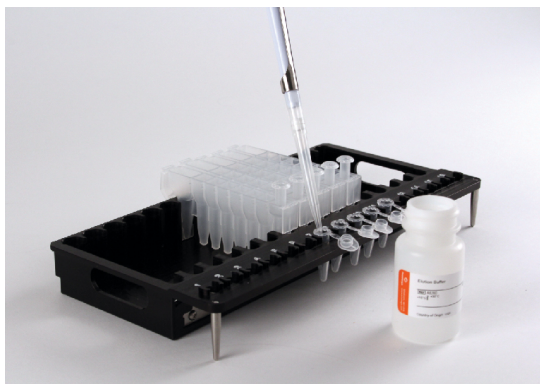
Figura 2. Preparazione e allestimento del vassoio. Il tampone di eluizione viene aggiunto alle provette di eluizione come indicato.
