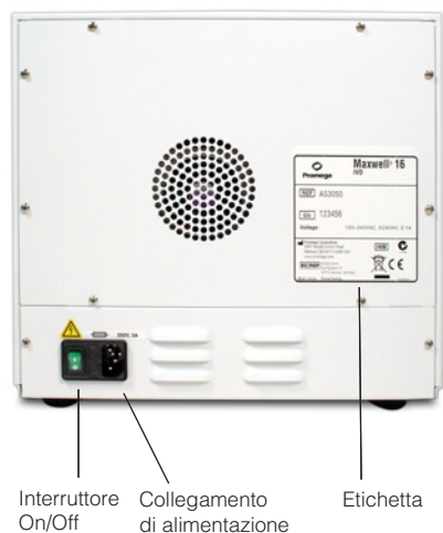
Figura 4. Interruttore di alimentazione sul retro del Maxwell® 16 IVD Instrument. Accanto all'interruttore di alimentazione si trova un fusibile ritardato da 3 amp. Questa figura illustra la parte posteriore dello strumento con l'interruttore di alimentazione e la connessione del cavo di alimentazione.
