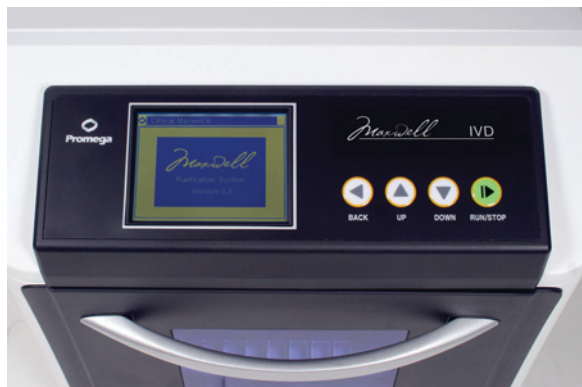
Figura 3. Touch screen e tastiera per la navigazione tra le schermate di visualizzazione del Maxwell® 16 IVD Instrument. Sulla tastiera e sulla schermata sono presenti le stesse selezioni di pulsanti. Entrambi i gruppi di pulsanti possono essere usati per navigare all'interno e tra le schermate. I pulsanti Back e Run/Stop consentono di navigare tra le schermate. I pulsanti Up e Down servono per navigare all'interno di una schermata.
