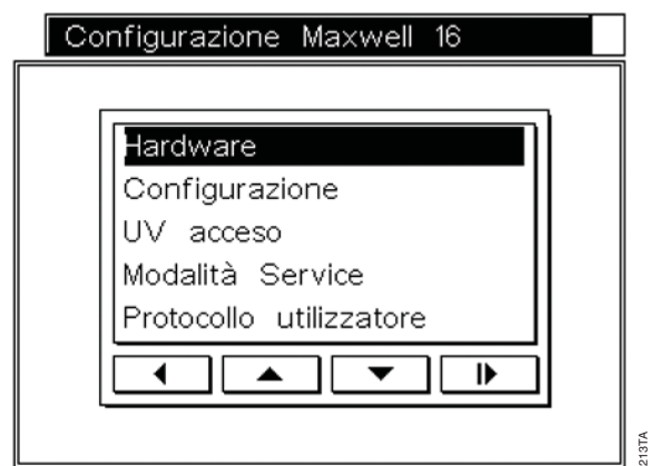
Figura 20. Schermata Configurazione Maxwell® 16. In questa schermata sono disponibili le funzioni per modificare le impostazioni dell'hardware ( Hardware ) e del firmware ( Configurazione ) (vedere Sezione 7). Inoltre, da questa schermata è possibile avviare la lampada UV ( UV acceso ; Sezione 8). Questa schermata consente di accedere alle funzioni di assistenza ( Modalità Service ; Sezione 11.B). Da questa schermata è anche possibile impostare i protocolli utilizzatore, selezionando Protocollo utilizzatore .
